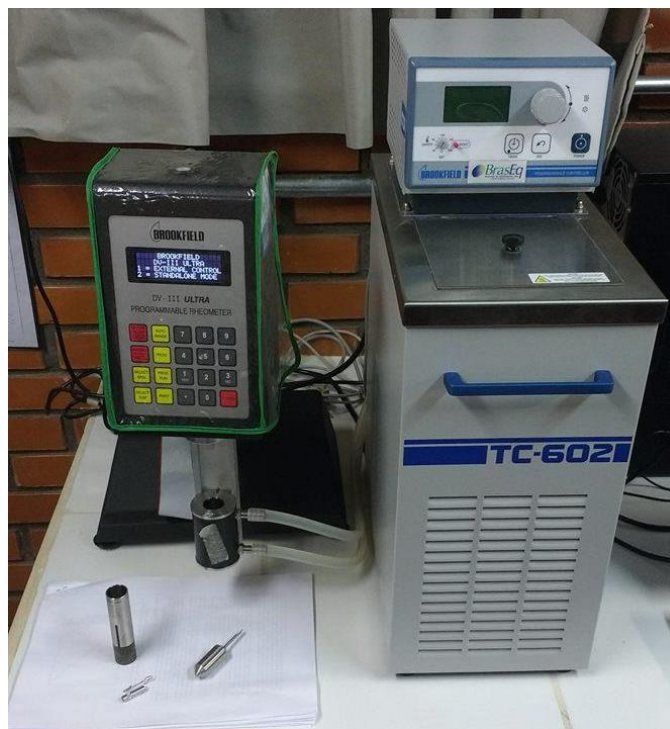
Figura 8 - Viscosímetro Brookfield DV-III Ultra, conectado no banho térmico.
